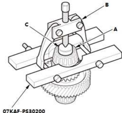
1. 使用轴承分离器、市售轴承拉拔器 (B) 和市售隔圈 (C) 拆下主传动轴滚锥轴承 (A)。
