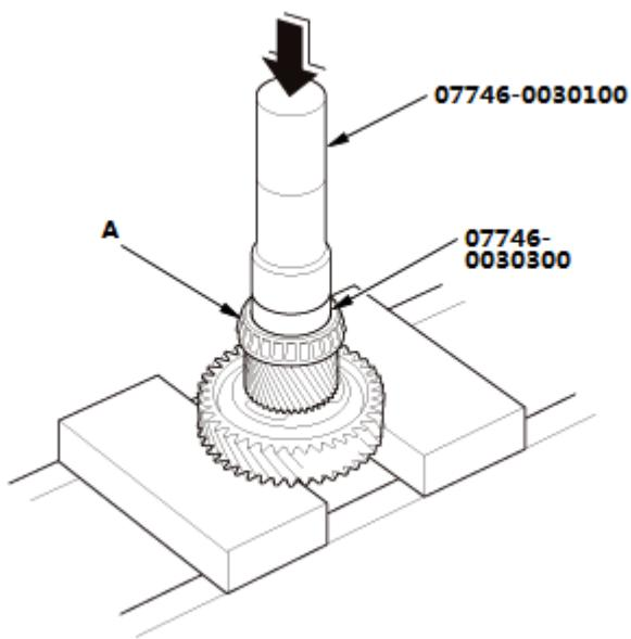
1. 用内径 40 mm 的拆装器手柄、内径 30 mm 的轴承拆装器附件和压力机安装副轴轴承 (A) 直至其压到底。
